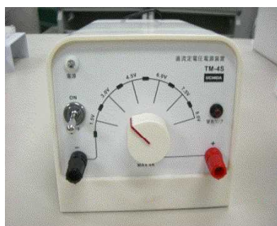
直流電源装置
