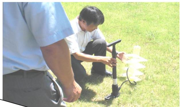
ペットボトルの中に入れられた水はボトルの中から動くまいとしているわけですが、ボトルに入れられた空気によって押し出されます。この場合勿論水も後ろに飛びますが、同じ力でペットボトルも水と反対の方向に押されることになるわけです。（※ 水が飛ぶことに注意すること）
