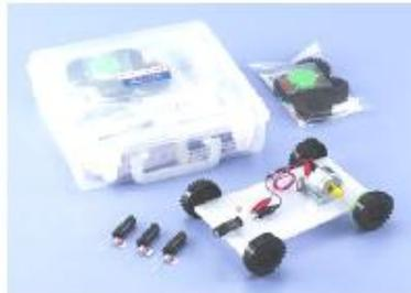
今回の工作では、午前中の第3学年の製作物（ゴム動力のペットボトルキャップを使った自動車）にモーターとコンデンサーを付け加えてコンデンサー自動車をつくります。
