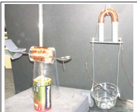
『着磁装置』(左)と『強力な電磁石』(右)
