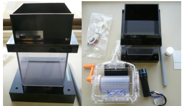
霧箱の様子（コールドプレートは土台部分）
